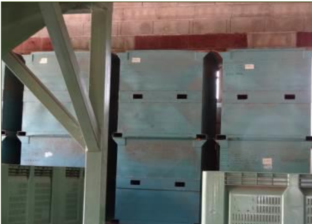
Séchoirs : l'air chaud passe sous ces caissons dont le fond est grillagé
