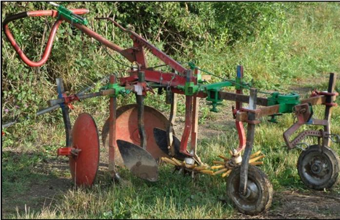
Les deux roues en position avant permettent de guider aisément l'outil. Le choix a été fait d'utiliser des roues dures et non pas gonflables, qui ont l'inconvénient de se dégonfler et de se crever facilement.
