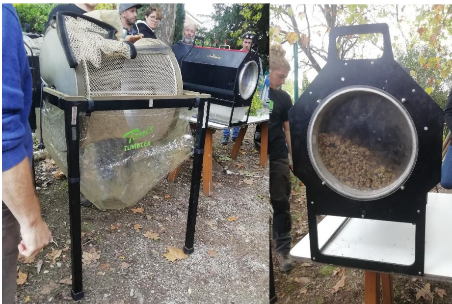
Figure 5 Photos des deux trimeuses présentées. A gauche, une trimeuse qui utilise les mailles d'un filet pour séparer la fleur de la trim. A droite, une trimeuse qui utilise des lames.
