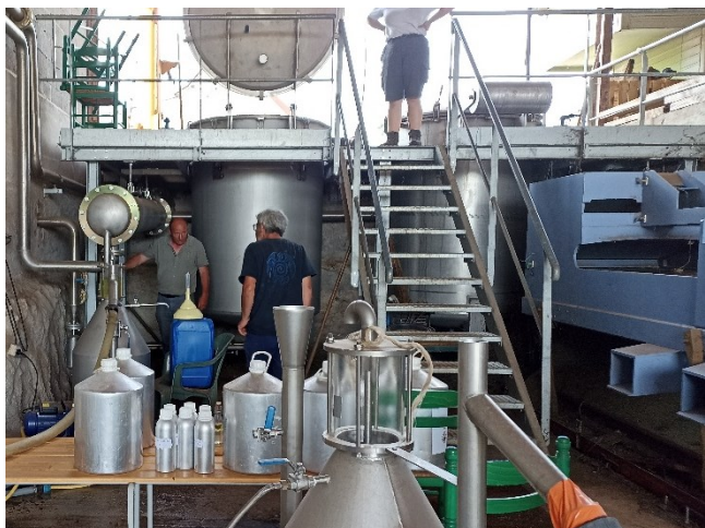
Distillation à la ferme, deux vases de 1000L permettent traiter de grandes quantités de matière. On prépare l'un en même temps que la distillation a lieu dans l'autre.
