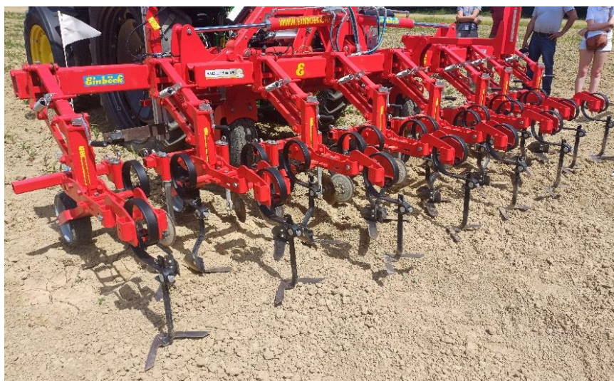
Bineuse Einboeck avec guidage camera
