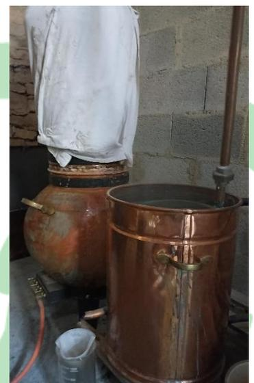
Un inconvénient du cuivre qui compose l'alambic concerne son entretien, qui doit être réalisé soigneusement pour ne pas endommager le métal. De plus, le matériau peut colorer les huiles obtenues, sans toutefois en altérer la qualité. Par ailleurs, une distillation à vide d'une trentaine de minutes est systématiquement opérée après chaque distillation, ce qui fait office de nettoyage (nettoyage plus intense au vinaigre et au sel en fin de saison d'utilisation).
