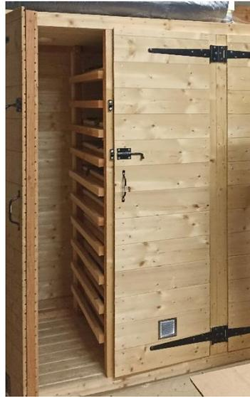
Durant les périodes où le séchoir fonctionne en continu, la succession des plantes dans les claies doit se faire en veillant de laisser les plantes humides toujours en haut, et les plus sèches en bas. Cela permet d'éviter que l'eau chargée en eau par les plantes les plus humides ne traverse des claies plus sèches, ce qui les rechargerait en humidité.
