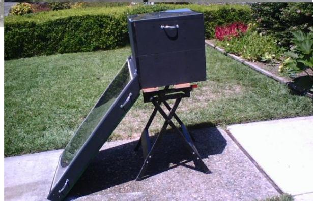
*Exemples de déshydrateurs à air chauffé par un collecteur solaire, dans plusieurs configurations. La sortie du collecteur pouvant être positionnée en bas de la chambre de déshydratation ou en haut. Voir conception. Source : Alejandro Deverre.*
