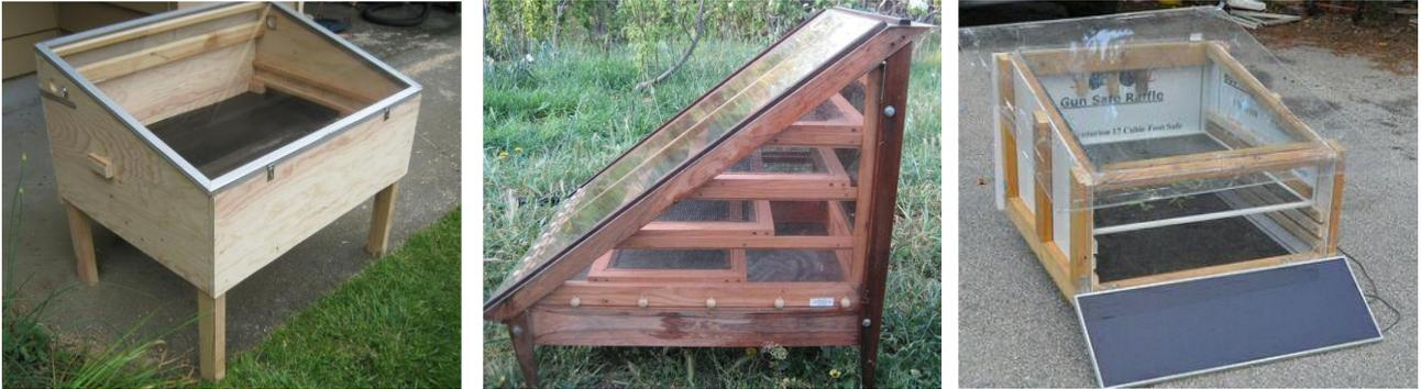
*Exemples de déshydrateurs solaires à rayonnement. Exemple d'hybridation photovoltaïque pour alimenter une ventilation assurant la circulation de l'air. Source Alejandro Deverre.*
