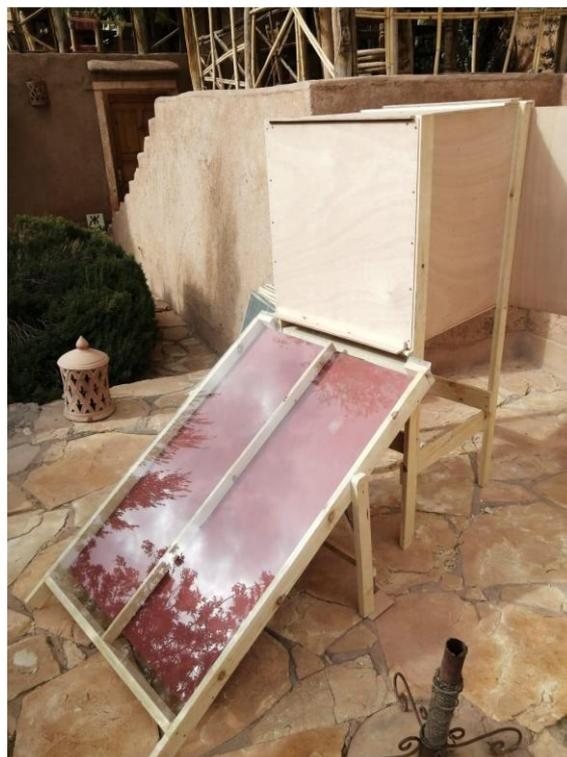
Déshydrateurs à air chauffé par un collecteur solaire (échangeur thermique à rayonnement direct). Autoconstruction Alejandro Deverre.
