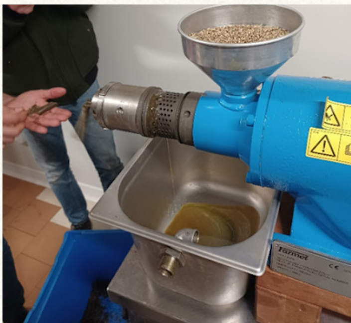
Presse axiale utilisée pour le pressage d'huile de chanvre à la ferme ©Gabb32
