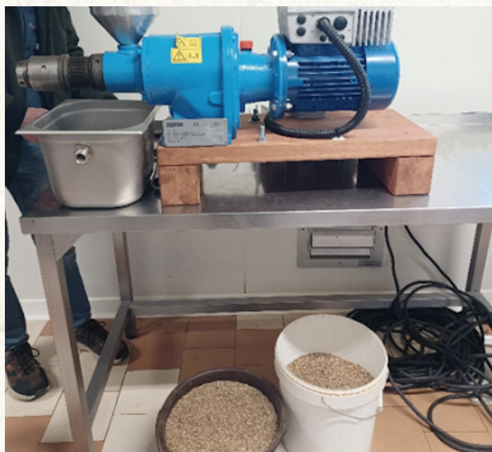
Presse axiale utilisée pour le pressage d'huile de chanvre à la ferme ©Gabb32
