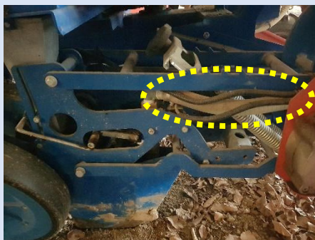
Socs de la planteuse et tuyau d'apport visible
