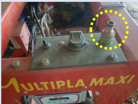
Branchement de la cuve à eau
